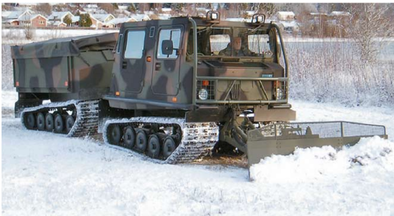
Bandvagn 206, extrautrustad med schaktblad och flak.
